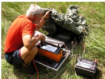
Obr. 5: Multielektrodivá aparatura ARS-200 E. V detailu jedna ze 48 elektrod umístěných na profilu.
