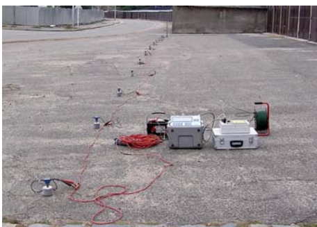
Obr. 3: Digitální seismická aparatura McSeis 1600 s dvaceti čtyřmi seismickými přijímači při měření v obtížných podmínkách s městskou zástavbou.
