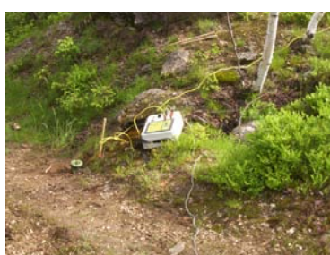
Obr. 6: Geoelektrická aparatura fy MEAS Prog. (model Libor) při přípravě odporového měření (vlevo) a měření bludných proudů (vpravo).
