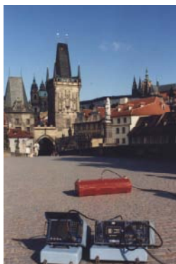
Obr. 4: Radarová aparatura SIR 10 s anténou v pozadí.
