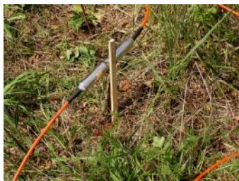
Obr. 5: Multielektrodivá aparatura ARS-200 E. V detailu jedna ze 48 elektrod umístěných na profilu.
