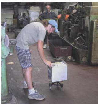
Obr. 2: Gravimetr CG-3M při měření uvnitř obývaného prostoru
