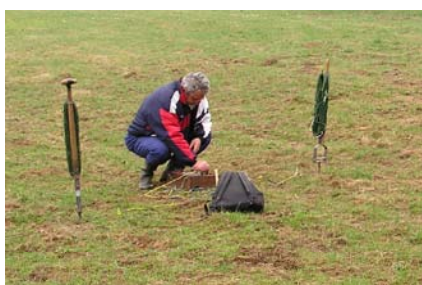
Obr. 6: Geoelektrická aparatura fy MEAS Prog. (model Libor) při přípravě odporového měření (vlevo) a měření bludných proudů (vpravo).
